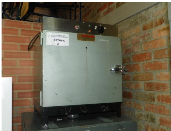
Foto 41. Estufa eléctrica para secado de muestras botánicas.
