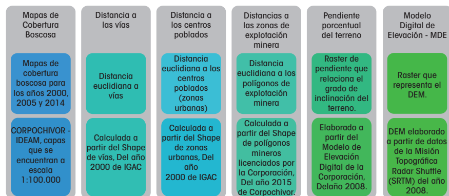
Figura 19. Determinación de variables e insumos cartográficos utilizados en la modelación de la deforestación futura
