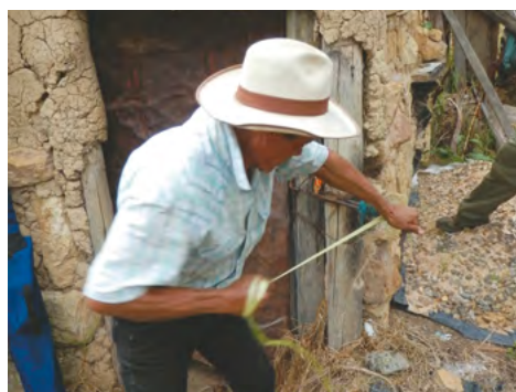
Proceso de extracción de la fibra empleando el sacador en el municipio de Boyacá.
